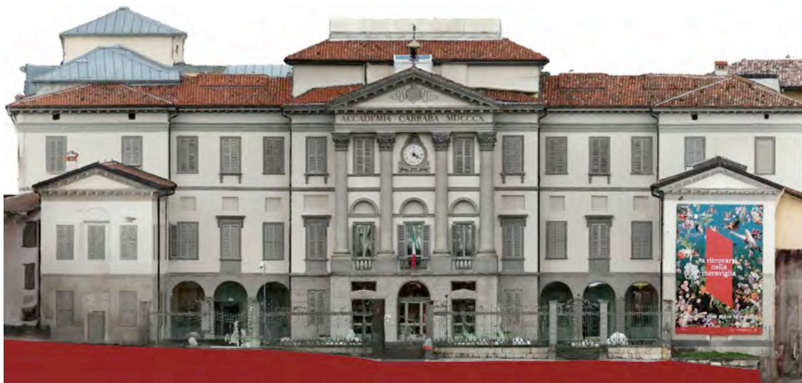
Fig. 10 – Ortofoto ottenuta dalle immagini inclinate riprese dal drone (RealityCapture)
