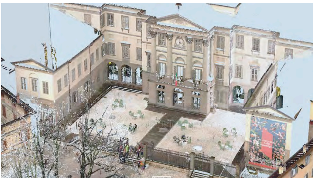
Fig. 9 – Restituzione iniziale dei punti acquisiti mediante la sessione con laser a scansione.
