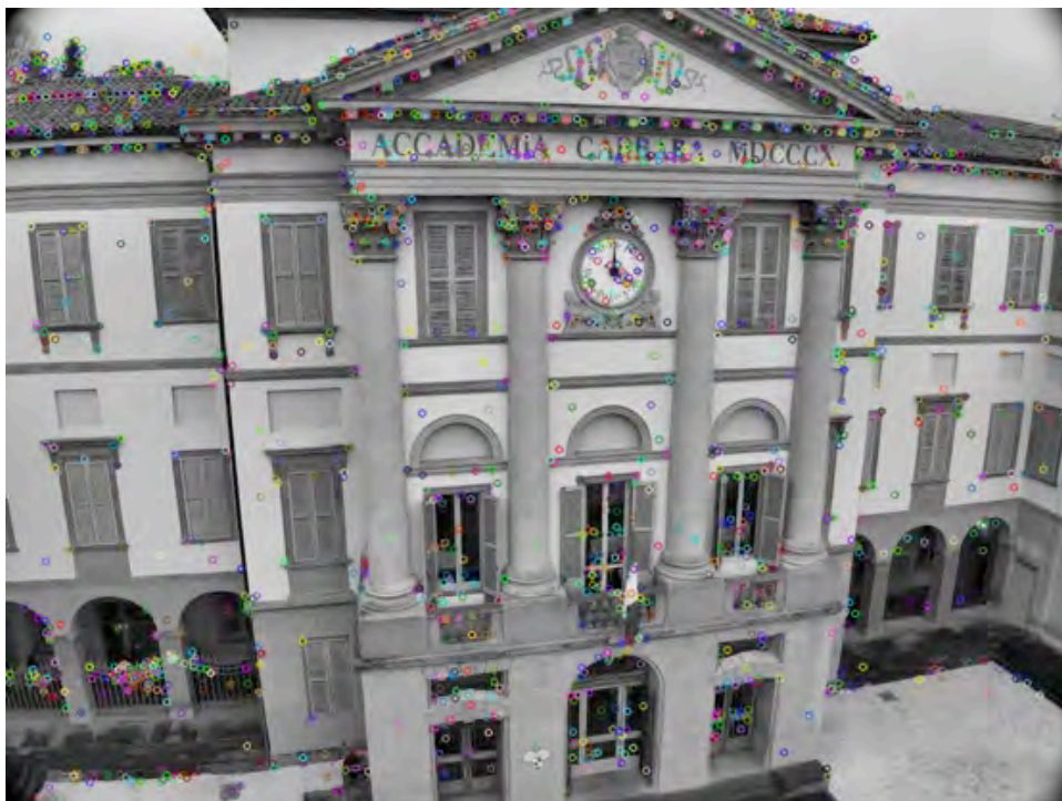
Fig. 1 - Ripresa inclinata da drone: esempio di individuazione di punti caratteristici (°) con algoritmo detector (SIFT) implementato con script didattico Python – ricerca settata a 2000 punti.
