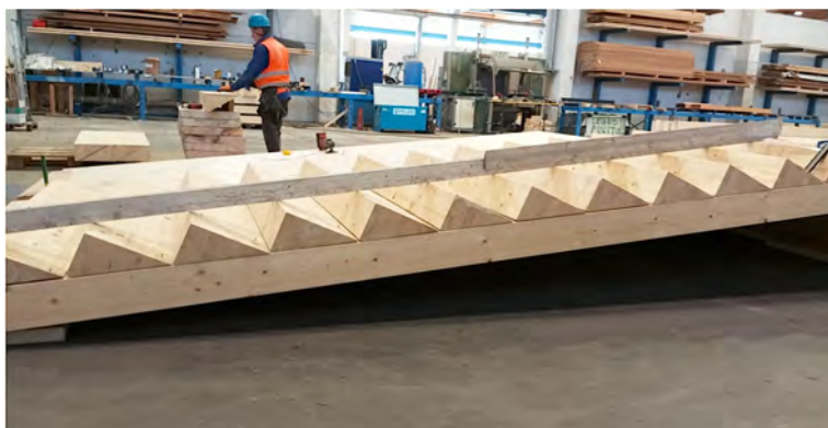
Scala in stabilimento e successiva fase di posa in cantiere
