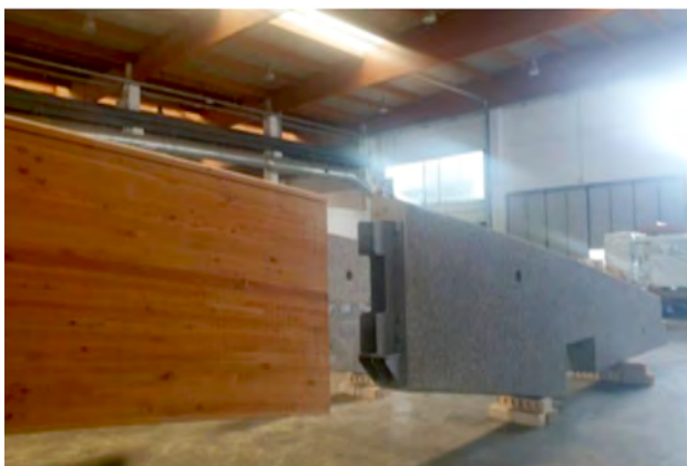
Prefabbricazione delle porzioni in calcestruzzo e delle travi in legno lamellare di larice
