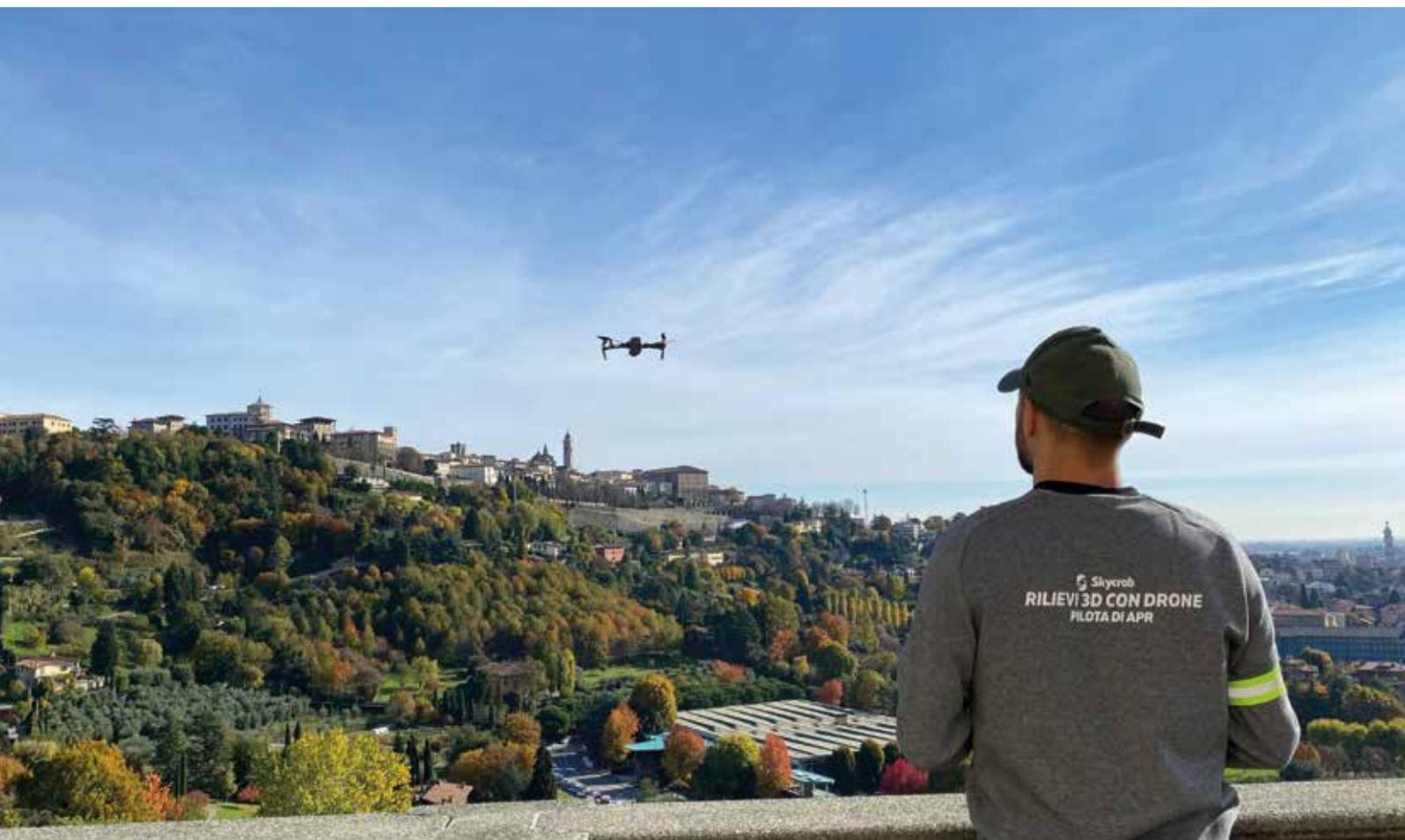
La fotogrammetria è una tecnica di rilievo che si basa sulle immagini fotografiche come dato fondamentale e di conseguenza per una fotogrammetria di qualità abbiamo la necessità di una buona fotocamera. Le camere montate oggi su questi piccoli dispositivi volanti dal peso inferiore ai 900 g, come il DJI Mini 2, il DJI Mavic Air 2 oppure il DJI Mavic 2 Pro, sono sufficientemente performanti per svolgere questa tipologia di rilievi.
