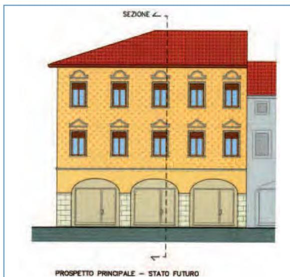
Il nostro condominio **DOPO** l'applicazione del cappotto – Trasmittanza 0,265 W/m<sup>2</sup>K
