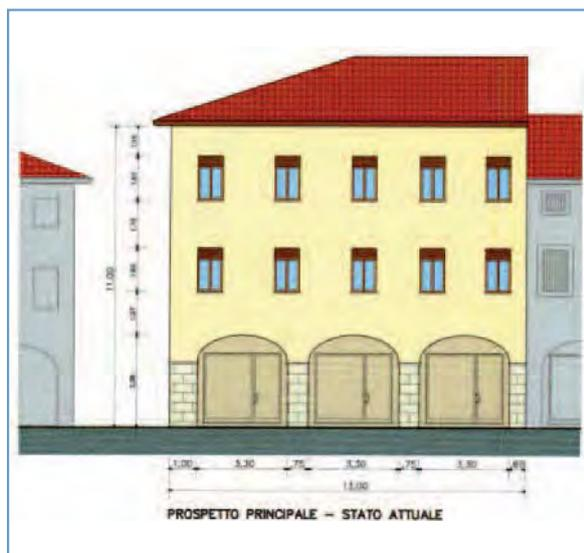
Il nostro condominio **PRIMA** dell'applicazione del cappotto – Trasmittanza 0,930 W/m<sup>2</sup>K
