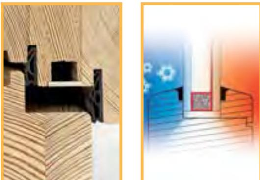
Il taglio di una finestra e di un telaio: s'identificano bene il legno lamellare a tre strati (in questo caso larice), il gocciolatoio e le due guarnizioni perimetrali.
