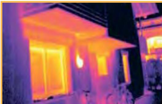
La termografia è un ottimo strumento per scoprire ponti termici – le parti chiare trasmettono calore, le parti scure hanno una trasmittanza termica molto bassa.
