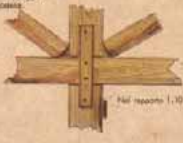
Fig. 3 - Il particolare dell'appoggio delle travi sulle cattedre.
