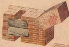
Fig. 4 - Il particolare della centina di legno per l'addossatura di un sordello.
