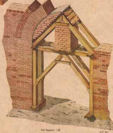
Fig. 2 - Una centina unitaria di travi di legno per una arca in tutto mattoni di mattoni in un muro pure di mattoni.
